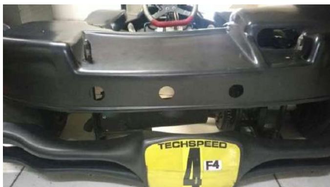
FUROS DE VENTILAÇÃO DE AR NA PARTE TRASEIRA DA CARENAGEM – DIAMETRO DE 44 mm E DISTÂNCIA ENTRE CENTROS DE 200 mm
