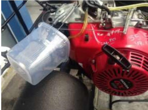
**16.10 FILTRO DE AR** – Obrigatório o uso do filtro de ar acoplado ao motor modelo turbo em tempo seco (modelo fornecido pela organização) e especial para chuva nesta condição (modelo fornecido pela organização). É obrigatório o uso do filtro de chuva quando o kart estiver com pneus WT.
