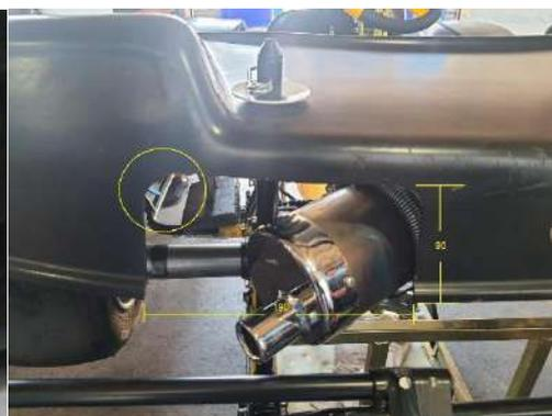
Aberturas de ventilação de ar na parte traseira da carenagem:
