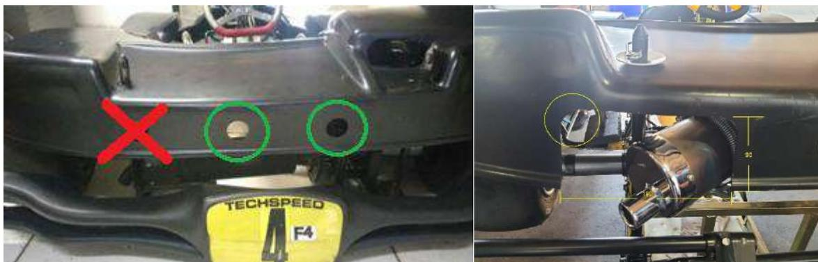
Aberturas de ventilação de ar na parte traseira da carenagem:
