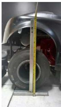
**ALTURA MÁXIMA DA CAIXA DE RODA TRASEIRA – 380 mm**
