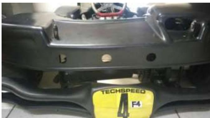
**10.1.2 ARESTAS CORTANTES:** Fica proibida qualquer saliência cortante e ou pontiaguda na parte traseira, que ultrapasse a linha do para-choque traseiro, exemplo: suporte de escapamento, suporte de placa, etc.
