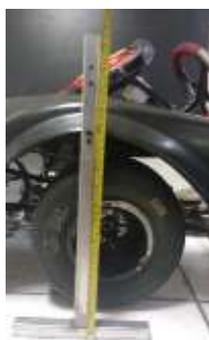
**ALTURA MÁXIMA DA CAIXA DE RODA DIANTEIRA – 300 mm**
