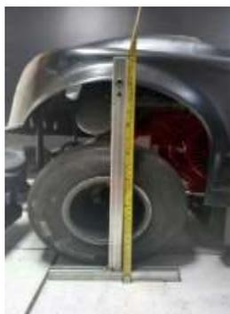
**ALTURA MÁXIMA DA CAIXA DE RODA TRASEIRA – 380 mm**
