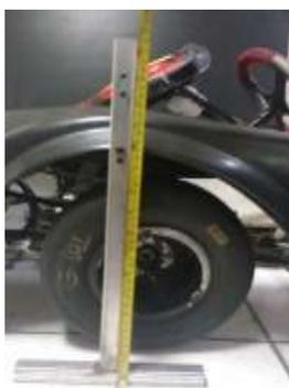
**ALTURA MÁXIMA DA CAIXA DE RODA DIANTEIRA – 300 mm**
