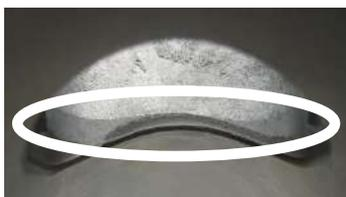
**4.5.6** A flange para a saída do escape pode apresentar finalização bruta (da fundição) ou usinada. A parte usinada pode ser lisa ou apresentar uma elevação circular para a vedação da junta.
