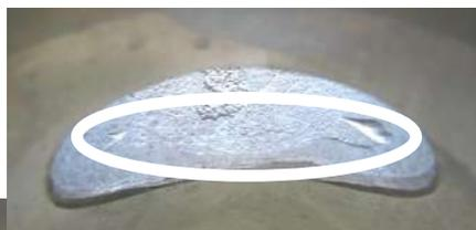
sinais de usinagem (CNC) em combinação com sinais de acabamento
