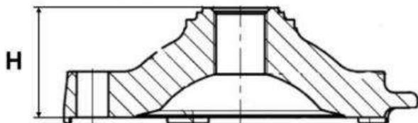
O perfil da câmara de combustão é verificado com a peça gabarito Rotax nº 277 390. A luz deve passar entre o gabarito e o cabeçote de forma uniforme por toda a extensão do perfil. Esta verificação serve apenas como referência. Em caso de dúvida devem ser feitas as devidas medições para verificação das dimensões especificadas neste parágrafo.
