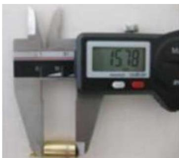
A parte semi-circular do atomizador tem a dimensão de  $5,8 \pm 0,3\text{mm}$
