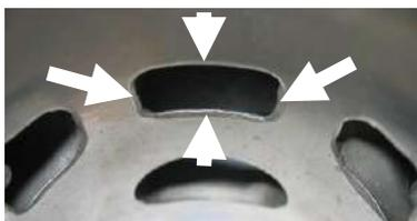
Os cilindros marcados, 223993, 223994 e 613933 podem apresentar marcas de usinagem feitas pela fábrica da Rotax.
