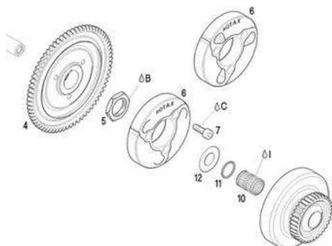
**5.3.6** A espessura da sapata da embreagem medida conforme a figura deve ter no mínimo:
