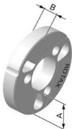
**5.3.8 Diâmetro exterior da campana.** O diâmetro exterior da campana da embreagem deve ser medido conforme indica a imagem. A medição deve ser feita somente na área da dobra na parte superior da campana (não na parte aberta) conforme a imagem. O diâmetro **mínimo** é de **89,50 mm**.
