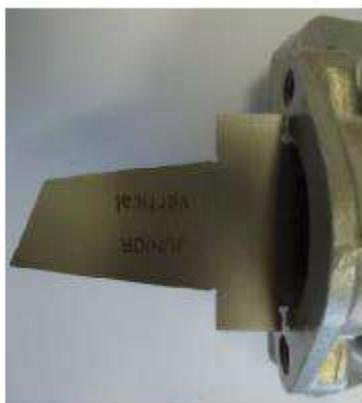
**4.5.7.** A distância entre o topo do cilindro e o topo da janela de escape deve ser verificado com a peça ROTAX 277 402. Inserir o gabarito de medição Rotax dentro do cilindro (certifique-se de usar a posição correta para JUNIOR, MAX ou DD2) e movimente a ferramenta (no ponto mais alto da janela de escape) tanto quanto possível dentro da janela. Nesta posição a ferramenta não pode tocar a parede do cilindro.
