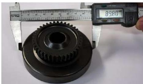
**5.3.9 Diâmetro interior do tambor.** A medição deve ser feita no meio (na área de contato entre a campana e a sapata). O valor **máximo** do diâmetro interior é de **84,90 mm**
