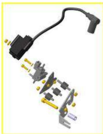
Para as versões de montagem de acordo com as duas últimas ilustrações a válvula magnética deverá ser montada através de apoios (coxim) de borracha à placa de suporte. (somente 125 MAX e 125 MAX DD2)
