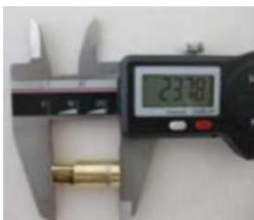
A parte cilíndrica do atomizador tem comprimento total de  $15,75 \pm 0,25\text{mm}$ .
