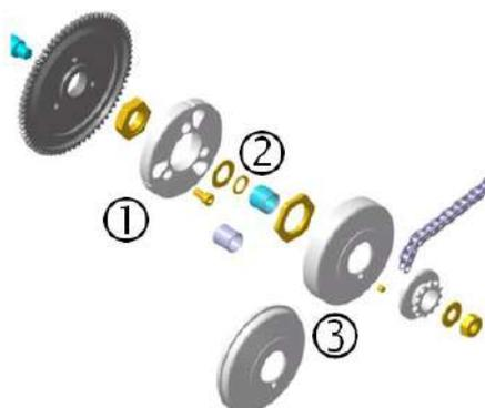
**5.3.1** Todos os motores deverão usar a gaiola 15x19x17 (indicado nas figuras acima com o número 9) ou a bucha de nylon 15x17x17,6 quando utilizado o pinhão de 11 dentes. Em ambos os casos deve-se utilizar o o’ring 12x2,5 original Rotax. O piloto deve certificar-se de que o o’ring não esteja tão desgastado a ponto de permitir a entrada de óleo ou graxa dentro da campana. A arruela interna da embreagem deve ser a original Rotax.
