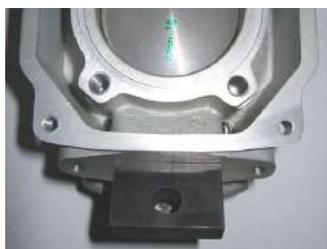
**4.6.2.** A modificação da junta (ref 250231) entre o cilindro e a base da válvula de exaustão não é permitida.
