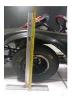
FRONT WHEEL BOX MAXIMUM HEIGHT – 300 mm FRONT WHEEL BOX MINIMUM HEIGHT – 290 mm
