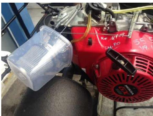
**16.8 FILTRO DE AR** – Obrigatório o uso do filtro de ar acoplado ao motor modelo turbo em tempo seco (modelo fornecido pela organização) e especial para chuva nesta condição (modelo fornecido pela organização). É obrigatório o uso do filtro de chuva quando o kart estiver com pneus WT.
