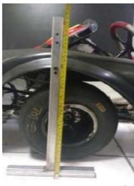
**ALTURA MÁXIMA DA CAIXA DE RODA DIANTEIRA – 300 mm**
