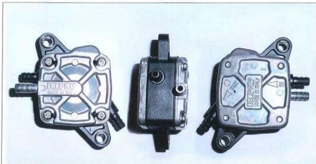
**Tutti i sistemi meccanici, manuali, elettronici ed ogni altro tipo di sistema forzato, sono vietati. E' ammesso come solo ed unico sistema per l'alimentazione, la pressione atmosferica. Ciò significa che è possibile utilizzare 1 (una) "pompetta d'alimentazione" di tipo pneumatico tra serbatoio e carburatore: Tale "pompetta" deve restare strettamente ORIGINALE.**
