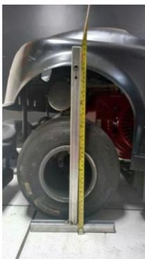
**ALTURA MÁXIMA DA CAIXA DE RODA TRASEIRA – 380 mm**
